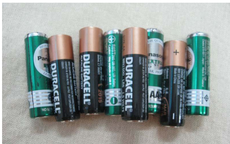
รูปที่ 8 ตัวอย่างแบตเตอรี่อัลคาไลน์รูปทรงกระบอกขนาด AA ที่ใช้ได้ครั้งเดียว
