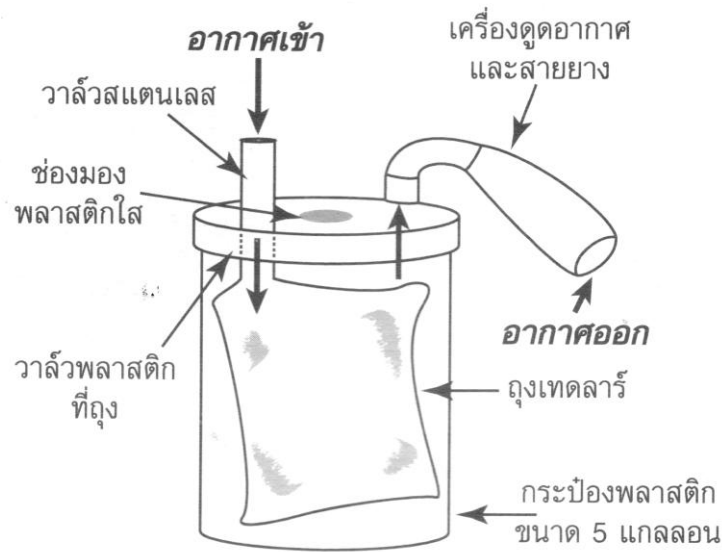
รูปที่ 2 ส่วนประกอบของกระป๋องเก็บอากาศ
